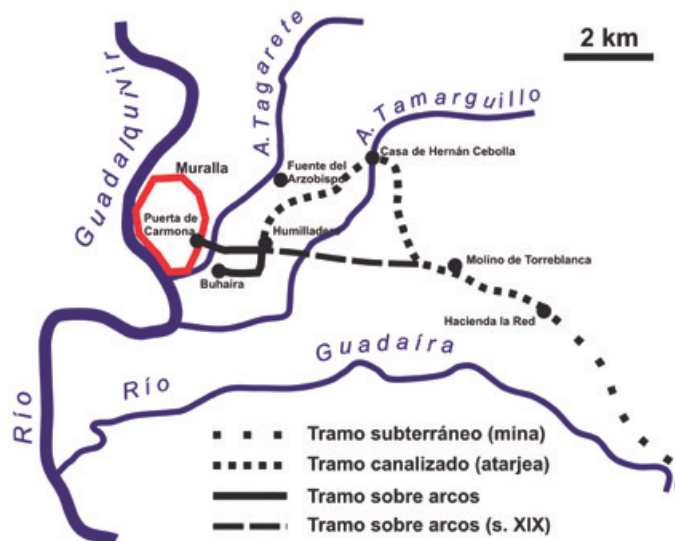
Figura 7. Esquema con el antiguo trazado de los Caños de Carmona (a partir de Jiménez-Martín, 1975).
